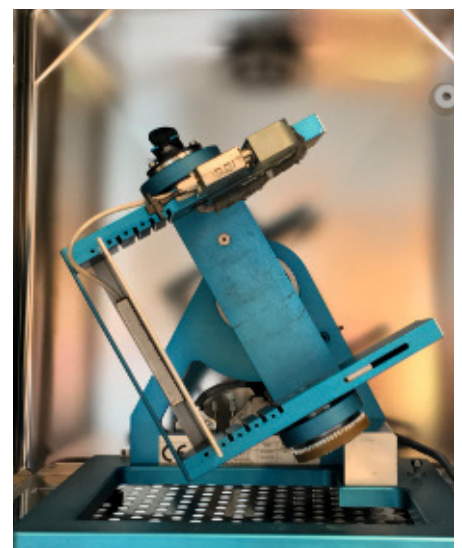
Abbildung 1: Mithilfe der Random Positioning Machine kann 3D-Wachstum induziert werden. (Fotos: Spheroids-Projekt)
